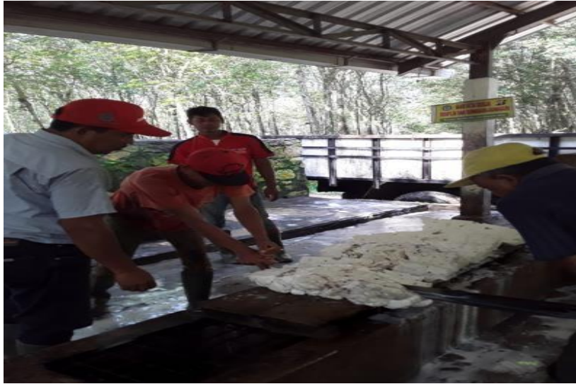
Gambar 11. Pembelahan cup lump menjadi 4 bagian.
