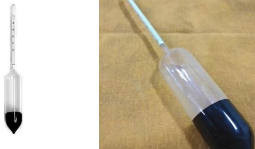
Gambar 9. Alat Metrolac untuk Mengukur DRC
