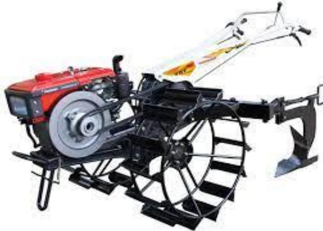
**Gambar 4. Traktor Tangan (*Hand Tractor*)**
